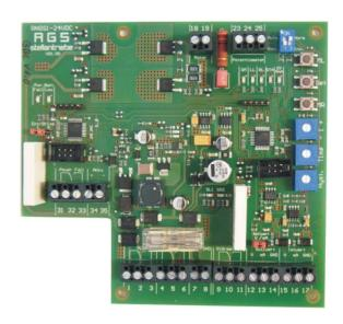
aktiven Rechtslauf und Linkslauf sowie Eingänge mit LED-Indikatoren zur Erkennung der Motorunterbrechung durch die elektromechanischen Endschalter des Antriebs.
